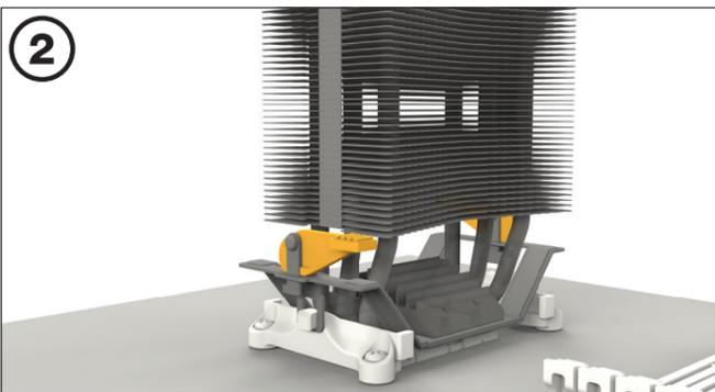
Mount the CPU cooler by rotating the AMD levers on both sides. Befestigen Sie den CPU-Kühler (1) beidseitig mit dem AMD Bügel. Ziehen Sie dazu beide Hebel fest.
