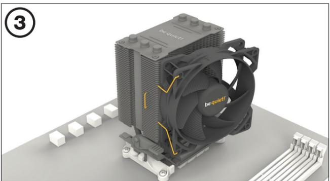
Fasten the 92mm fan (2) onto the cooler unit (1) using fan clips (4). Connect the fan to the motherboard's PWM signal. Befestigen Sie den 92mm Lüfter (2) mit Hilfe der Lüfterklammern (4) am Kühler (1). Anschließend verbinden Sie den Lüfter mit dem CPU-Lüfteranschluss des Mainboards.
